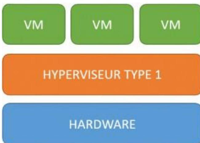
Un Hyperviseur de type 1 s'installe directement sur la couche mat rielle du serveur et au d marrage d'une machine physique, celui-ci prend directement le contr le du mat riel
