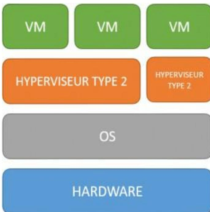
Un hyperviseur de type 2 est assez comparable à un émulateur car celui-ci s'installe sur un système d'exploitation déjà en place. Il se démarre la plupart du temps comme une simple application.
